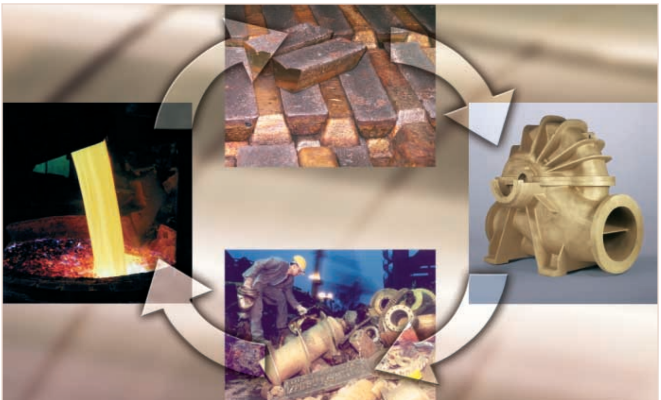
Bronze – der Kreislaufwerkstoff: Metallgewinnung, -verarbeitung, -nutzung und -rückgewinnung am Beispiel von Gussteilen
