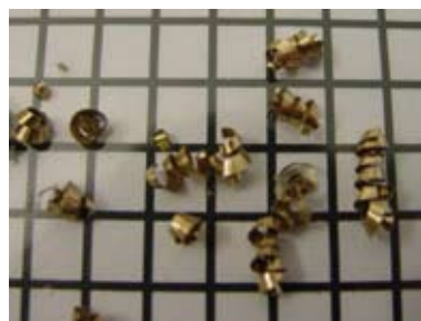
Bild 3: Späne nach Außendrehen unter gleichen Bedingungen von links BlueBrass®42, Mitte CuZn39Pb3; rechts CuZn36
