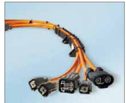
Bild 9: Kabelbaum aus dünnen Litzen
