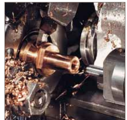
Bild 5: Spanbildung gut zerspanbarer Werkstoff CuTeP
