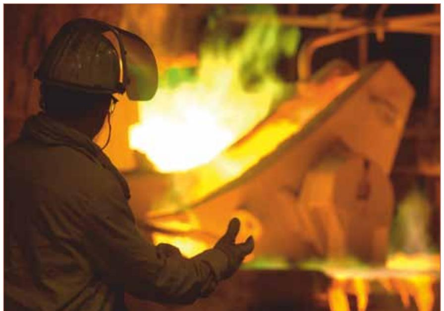
Um auf die notwendige Reinheit des Anodenkupfers von ca. 99 Prozent zu kommen, erfolgt im Anodenofen eine Raffination durch Einblasen von Luft und Sauerstoff. Nichtkupferhaltige Verunreinigungen wie Zinn, Blei, Nickel und auch Zink werden in einer Schlacke angereichert, welche wieder in die erste Stufe zurückgeführt werden. Der hierbei vom Kupfer aufgenommene Sauerstoff muss nach der Raffination durch eine Reduktion mit Erdgas oder Polholz entfernt werden.
