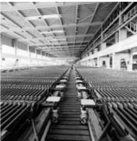
Bild 7: Blick in die heutige, hochmoderne Cu-Raffinations-elektrolyse der Norddeutschen Affinerie in Hamburg (Foto: Norddeutsche Affinerie)
