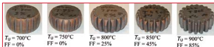
Bild 7: Geschmiedete Zahnräder aus Cu99 im Temperaturbereich 700\text{ °C} \leq T_U \leq 900\text{ °C}
