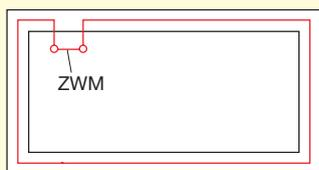
5 Durchgangsprüfung mit dem Zangen-Widerstandsmesser („Erdungsprüfzange“) an der Einsatzstelle ZWM
