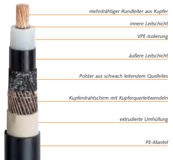
Bild 18: 20 kV-VPE-Kabel längswasserdicht
