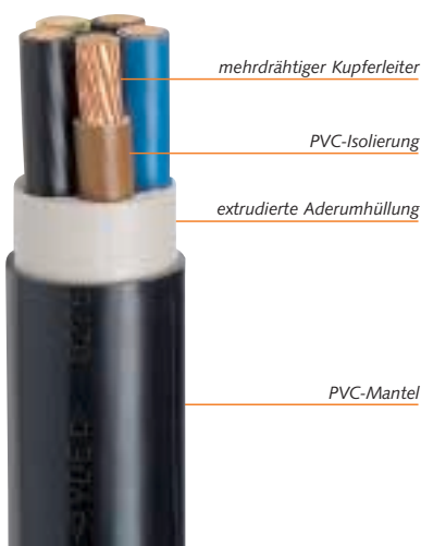
Bild 16: 1 kV-Starkstromkabel
