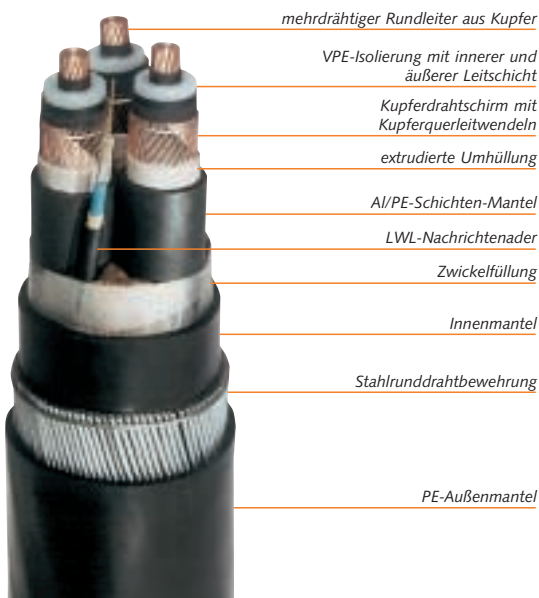
Bild 21: 20 kV-VPE-Seekabel
