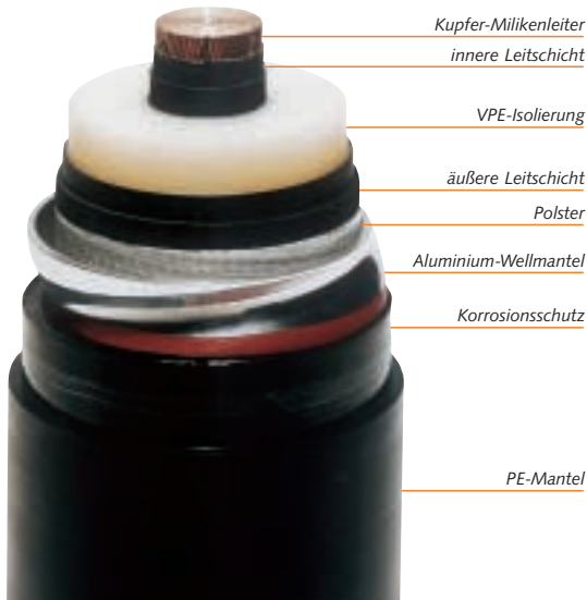
Bild 20: 400 kV-VPE-Kabel
