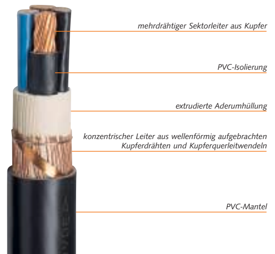
Bild 17: 1 kV-Starkstromkabel mit konzentriertem Leiter
