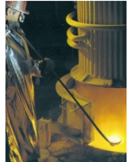
Transport eines erhitzten Messingblocks zum Strangpressen
