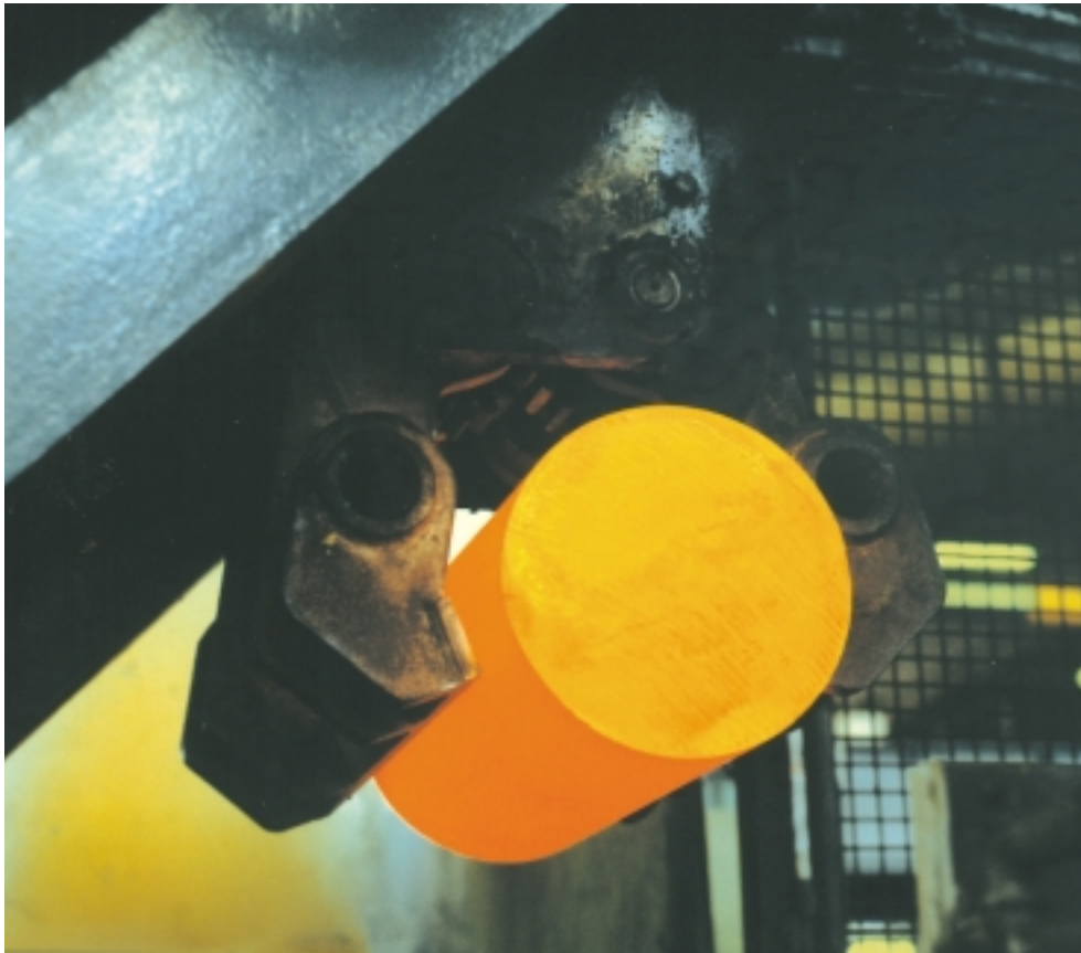
Transport eines erhitzten Messingblocks zum Strangpressen
