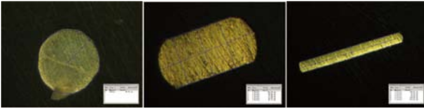
Bild 5: Veränderung der Geometrie in Abhängigkeit des Umformgrades. Links Ausgangsmaterial (1.000fach), Mitte 30% gewalzt (2.000fach) und rechts 70% gewalzt (1.000fach)
