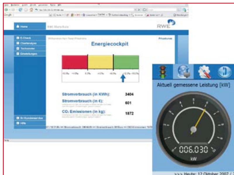
Bild 3: SmartMetering-Assistenzsystem mit TV- und Handy-Nutzerschnittstelle
