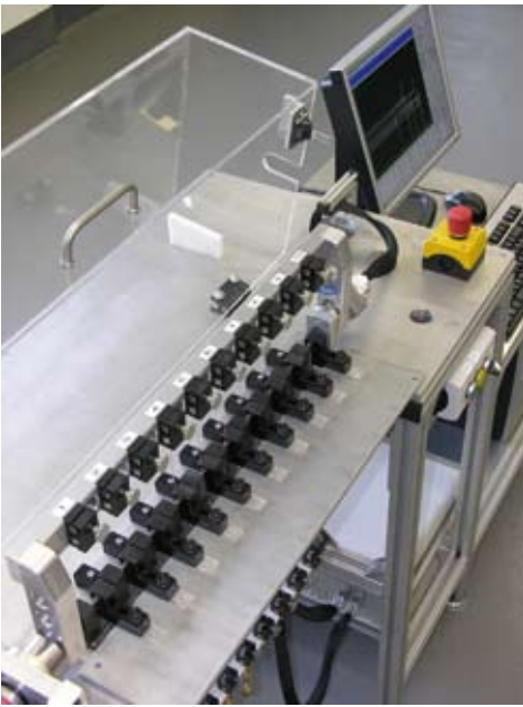
Bild 6: Testmaschine für die Feststellung der Biegewechselfestigkeit [7]
