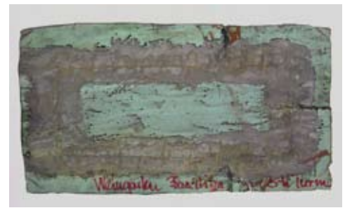
Bild 8: Geflicktes Kupferblech vom Dach der Basilika in Weingarten
