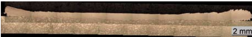
Bild 4: Querschliff einer Unterwasserschweißung mit den typischen Unterscheidungen an beiden Seiten
