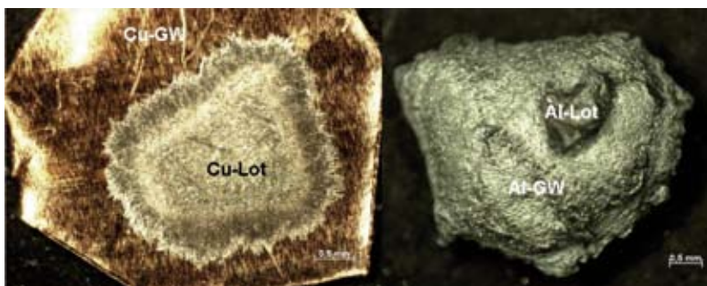
Benetzungsversuche ESEM; links: Grundwerkstoff (GW): Cu-DHP; Lot: Cu77NiSnP-600/630, ohne Flussmittel, Vakuum; rechts: Grundwerkstoff (GW): EN AW-ALMn1Cu, Lot: AlSi10 (Draht), ohne Flussmittel, N 2
