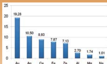
Bild 5: Dichte verschiedener Leiter in g/cm³
