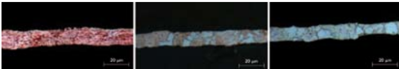
Bild 5: Dickenverteilung bei 10 µm: (links) vor Glühen, (Mitte) Glühen bei 300 °C, (rechts) Glühen bei 400 °C
