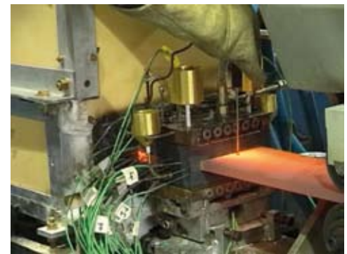
Bild 4: Gießbetrieb mit Einsatz der Flüssigmetallkühlung
