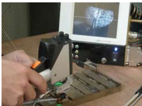
Bild 3: Manuell geführtes Laserstrahlschweißen an einer Platte aus CuAl10Fe5Ni5
