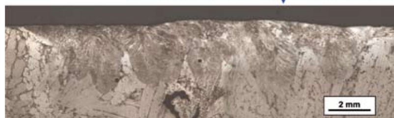
Bild 9: Querschliff einer manuellen Laserstrahlschweißung mit Porosität im Grundwerkstoff
