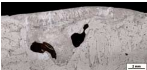
Bild 7: Querschliff einer manuellen Laserstrahlschweißung mit Poren im Schweißgut
