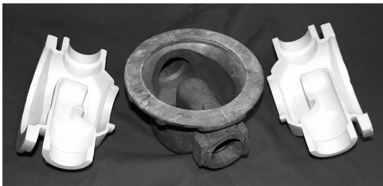
Bild 4: Messing – Rückschlagventil, zweiteiliges EPS – Modell (Foto: Irish Foundry, USA)
