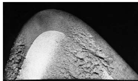
Bild 1: Durch Kavitationserosion geschädigte Spitze eines Schiffspropellers
