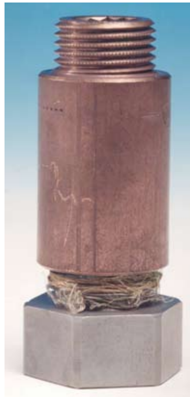
Bild 3: Hahnverlängerung mit Prüfkörper
