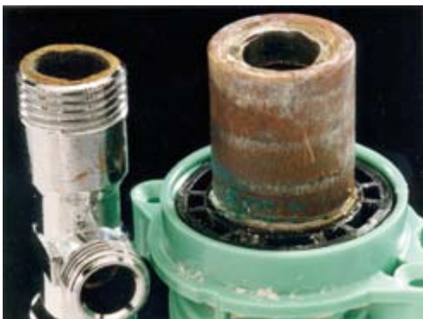
Bild 1: Beispiel für ein gebrochenes Eckventil
