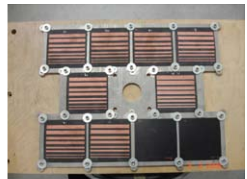
Bild 4: Probenaufnahmen für den Shakertest; Testkörper: PA6 GF15 mit 200 µm Kupfer
