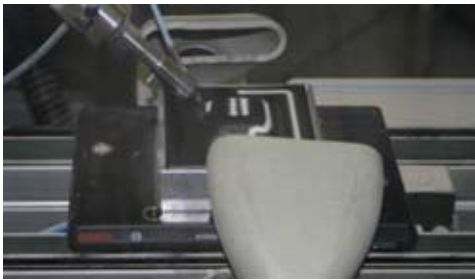
Bild 2: Aufbringen einer Leiterbahn aus Zinn auf ein räumliches Bauteil aus PA 6, 15 % Glasfasergehalt
