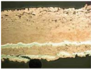
Bild 5: Schliff durch eine 1000 µm dicke Schicht besteht aus Kupfer und Zinn (helle Schichten)
