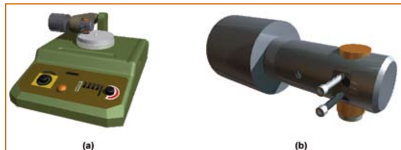
Bild 6: Darstellung des Taber Abraser Verschleißtestes (a) und der konstruierten Probenaufnahme (b)
