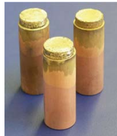
Bild 3: Gegenüberstellung der thermisch gespritzten (links) und pulvermetallurgisch hergestellten (rechts) Schleifstifte
