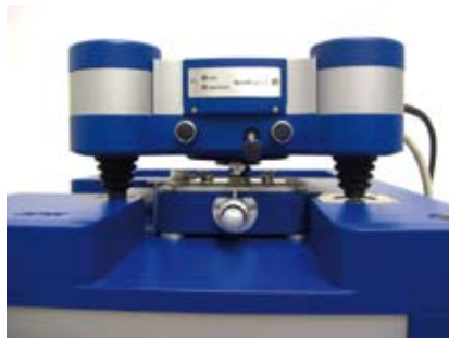
Bild 4: Die BioMAT Workstation von JPK Instruments kombiniert AFM (links) mit Epifluoreszenz (rechts).
