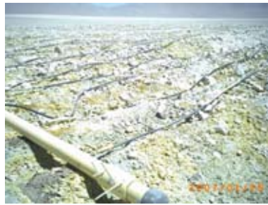
Bild 2: Biologische Haufenlaugung in Chile zur Gewinnung von Kupfer. Die Höhe der Anlage beträgt ca. 165 m. Perkoliert wird durch Schlauchsysteme, die auf der Haufenkrone verlegt sind. (Übersicht und Detail)
